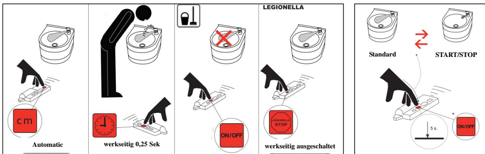
Veränderbare Elektronikparameter Reichweite 0,1 - 0,3 m Laufzeiten 0,25(Standard) - 7,75 Sek Ein/Aus Aktivierung, Adaptierung der Legionellenspülung über Remotecontrol 6 - 168 h Vom Standardprogramm in START/STOP-Modus Auf der Remotecontrol den ON/OFF-Knopf 5 Sekunden drücken
